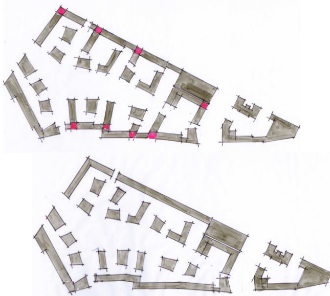
Abbildung 18: Baustruktur mit geschlossenen Gebäuderiegeln, ohne und mit abgerückter hinterer Bebauung (Quelle: wagner Planungsgesellschaft 2019)
